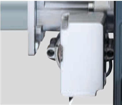
RS 25/E BLU型及RS 200/E BLU型燃烧器调整燃料供应的步进式电机示例。
