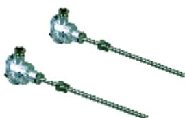
这一组件包括两个温度传感器：一个空气传感器和一个废气检测器。他们必须与氧气控制组件相连接，这样LMV52程控器可以计算出燃烧效率，计算后的燃烧效率数值会显示于AZL面板上。
