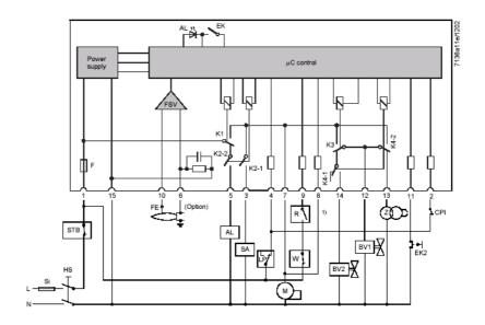
报警设备 QRB1B 光敏火焰探头 AL BV... 燃料阀 QRC... 兰色火焰探头 bl 兰色 CPI 位置关闭指示 EK 锁定复位按钮 br 褐色 EK2 远程锁定复位按钮 sw 黑色 F 内置保险 温度或压力控制器 R 离子探针 执行机构 FE SA FSV 火焰信号放大器 供电回路主保险 Si HS 主开关 STB 温度安全限定 OW 燃油预热器接点 K... 控制器延时接点 LP 空气压力开关 W 温度或压力限制器 M 燃烧器马达 Z 点火变压器
