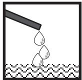
Kondensat darf nicht in das Gerät gelangen kann. Bei Minustemperaturen, durch Vereisung Fehlfunktion/Ausfall möglich.
